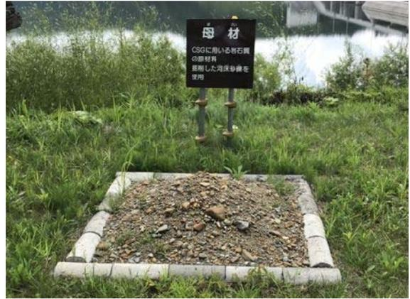
CSG の母材（現地河床の砂礫）
