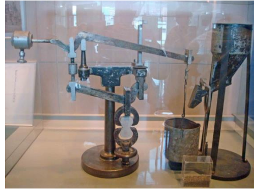
写真-7 モルタルブリケットの試験機
